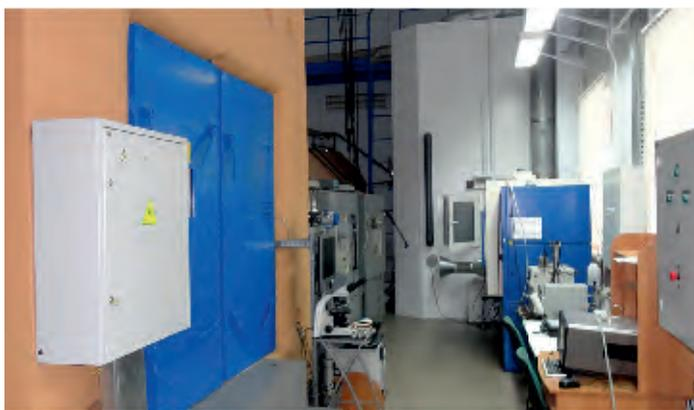
*Автоматизированный стенд на базе горизонтальной аэродинамической трубы НПО «Тайфун» для оценки эффективности генераторов льдообразующих аэрозолей*
