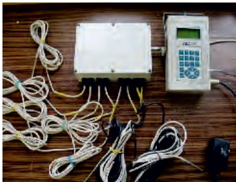
Рис. 6. Почвенный термометр АМТ-5
