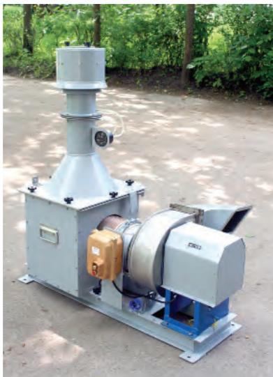
*Рис. 7. Установка воздухофильтрующая малогабаритная*
