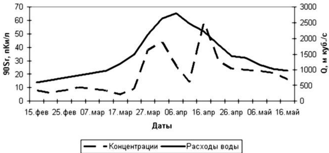
Рисунок 1. Гидрограф стока и концентрация ^{90}\text{Sr} в водах р. Припять в период весеннего половодья 1999 г.
