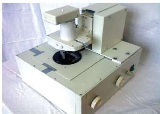
Рисунок 2. Двухкоординатный компьютеризированный сканер комплекса «ХРОМОСОМА»
