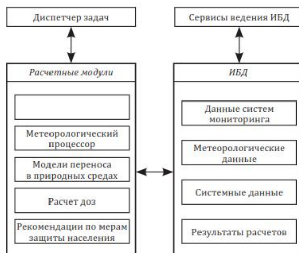
Рисунок 1. Общая схема взаимодействия компонентов серверной части
