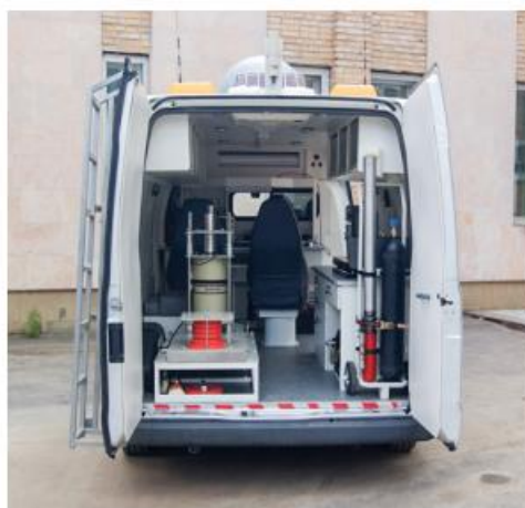
Рисунок 3. Автомобильная лаборатория радиационной разведки (АЛРР)
