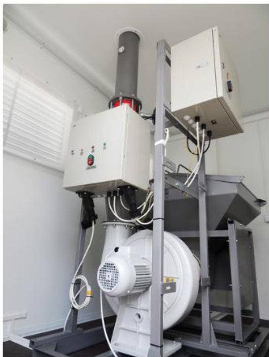
Рисунок 2. Установка воздухофильтрующая УВФ-2
