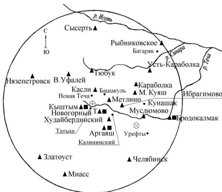
Рис. 2.1. Расположение пунктов радиационного мониторинга в 100-км зоне вокруг ПО «Маяк» и ПЗРО: ■ – наблюдения за атмосферными аэрозолями; ▲ – отбор проб атмосферных выпадений с суточной экспозицией и наблюдения за \gamma -фоном; Т – отбор проб атмосферных осадков; ⊕ – ПО «Маяк»; ⊗ – ПЗРО Челябинское отделение филиала «Уральский территориальный округ» ФГУП «РосРАО» (бывший Челябинский СК «Радон»).
