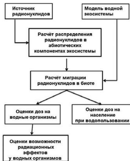
Рис. 5.5. Блок-схема динамической радиоэкологической модели «ECOMOD» для водной экосистемы.
