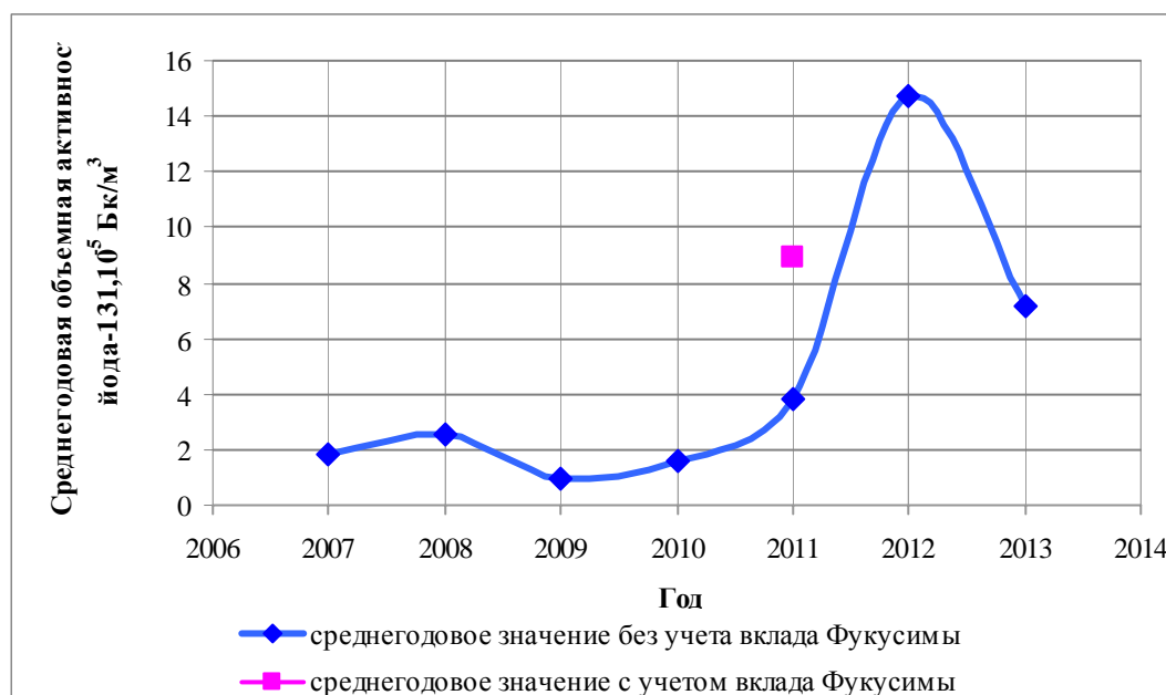
Рисунок 1 – Динамика среднегодовой объемной активности ^{131}\text{I} в приземном слое воздуха г. Обнинска в период 2007-2013 годов.
